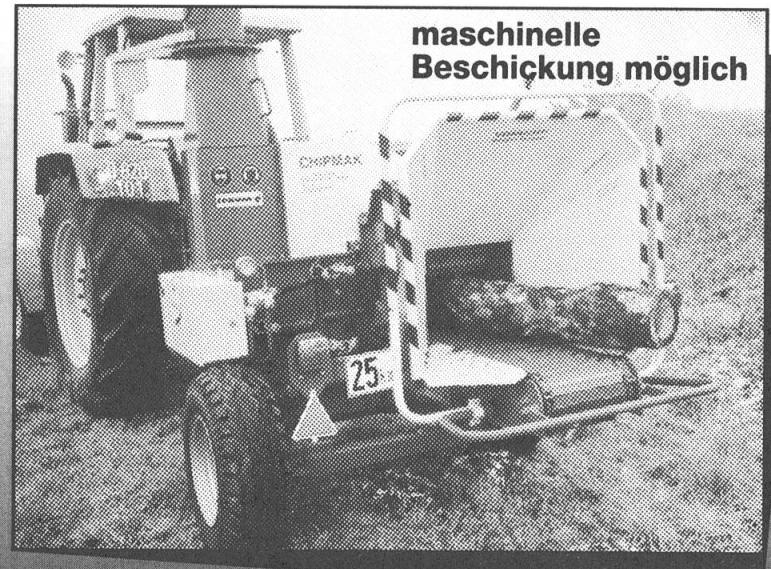
• **Einzugsförderband • Patentierter Walzeneinzug mit zusätzlicher Vorpresswalze • Kreuzhacksystem patentiert • Einzugssteuerung Chiptronic dadurch wird Ihr Traktor geschont**
