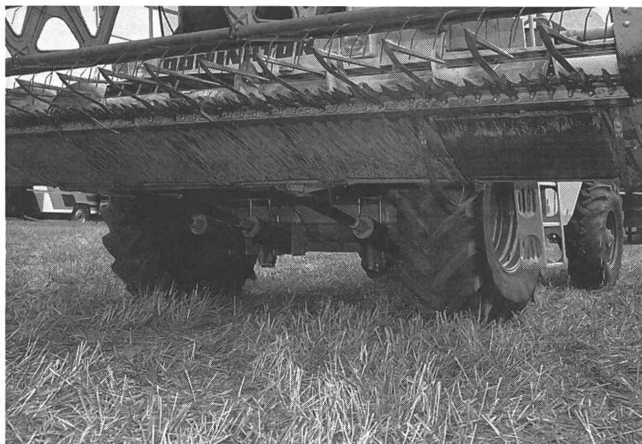
Schneidwerksteuerung AUTO CONTOUR mit elektronischer Verrechnung von Schneidwerkhöhe, -querneigung und Bodenentlastung.
