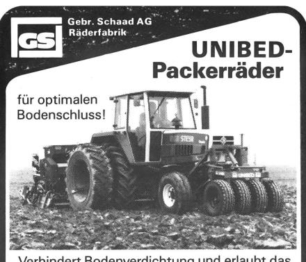
Verhindert Bodenverdichtung und erlaubt das Säen gleich nach dem Pflügen im Einmann-Passage-Verfahren.
