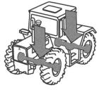
Bodenschonung ist eine der Stärken des MB-trac. Denn im Arbeitseinsatz ist das Gewicht gleichmäßig auf beide Achsen verteilt und schränkt so den Bodendruck weitestgehend ein.
