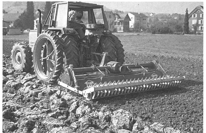
Abb. 11: Entscheidender Faktor für die Bearbeitung ist die Bodenfeuchtigkeit. Rechts oben: Der Vorteil der Stabwalze besteht darin, dass sie bei zu nassem Boden verklebt und damit die Saatbettbereitung verunmöglicht. Links: Bei optimaler Bodenfeuchtigkeit ist die Stabwalze der Packerwalze vorzuziehen. Rechts unten: Die Packerwalze kann mit ihren Abstreifern praktisch jederzeit eingesetzt werden und eignet sich somit für Gerätekombinationen.
