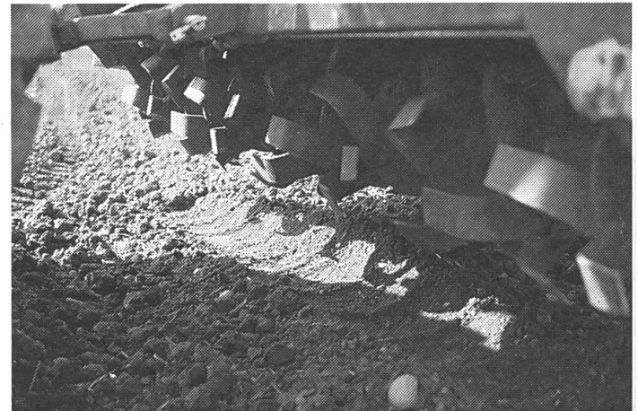
Abb. 8: Zur Vermeidung von Bodenstrukturen – insbesondere nicht offensichtlicher Schäden wie Aggregatverdichtung und Verlust der Humushüllen – muss beim Einsatz zapfwellengetriebener Geräte durch Erhöhung der Fahrgeschwindigkeit und Herabsetzung der Werkzeumdrehzahl die Bearbeitungsintensität reduziert werden. Links: Kreiselegge. Rechts: Zinkenrotor (oben); Bodenfräse (unten).
