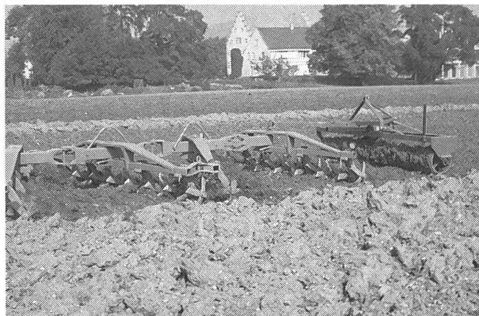
Abb. 6: Trotz des groben Saatbettes werden mit dieser universellen, schweren Spatenrollegge immer wieder ausgezeichnete Resultate erzielt – mit und ohne Pflanzenreste. Links: Saatbettbereitung mit kombinierter Rauhwalze. Rechts: Die vier hintereinander angeordneten Spatenwellen lassen sich für den Transport akkordeonartig zusammenschieben; sehr bedauerlich, dass diese Ausführung in der Schweiz nicht mehr erhältlich ist.
