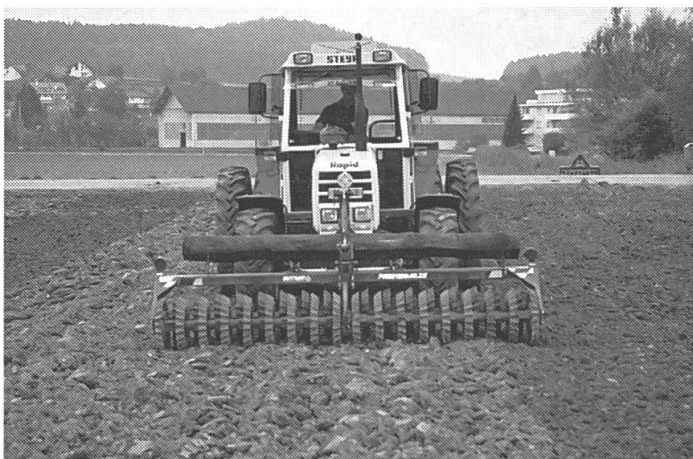
Abb. 12: Ein Packervergleich auf mittelschwerem Lehm Boden ergab bei Winterroggen keine Ertragsunterschiede. Der Ring- und der Spiralpacker sowie die Prismenwalze im Frontanbau (links) waren gleichwertig. Mit dem kombinierten Pflug-nachläufer Doppelpacker/Crosskillwalze (rechts) konnte ein Arbeitsgang eingespart werden, indem gleichzeitig gepflügt und das Saatbett bereitet wurde. Die zusätzliche Rüstzeit für die abgebildete Kombination beträgt rund 25 Minuten je Feld, der zusätzliche Zugkraftbedarf beim Pflügen 20%.
