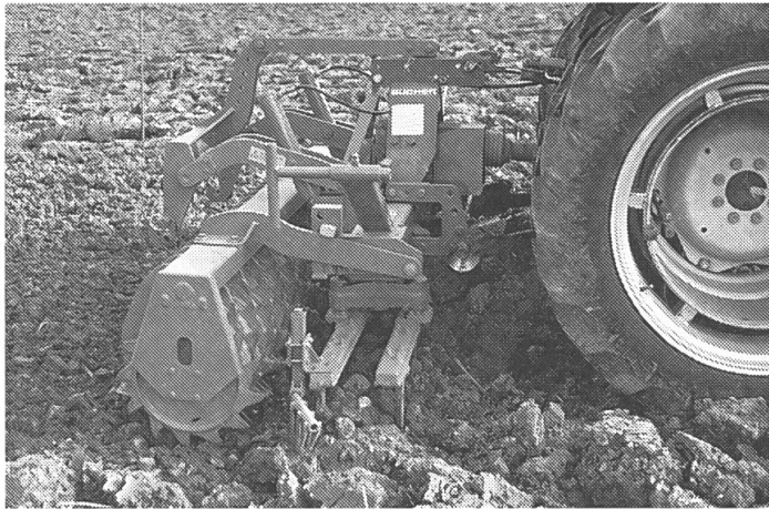
Abb. 7: Die Rüttelegge zeichnet sich durch ihren Ausebnungseffekt sowie durch einen geringen Leistungsbedarf aus. Links: Die gross dimensionierte Packerwalze trägt zur weiteren Zerkleinerung und zur Rückverfestigung des Bodens bei. Rechts: Bei günstigen Bodenverhältnissen können mit dieser schlagkräftigen Gerätekombination Saatbettbereitung und Saat in einem Arbeitsgang erfolgen.
