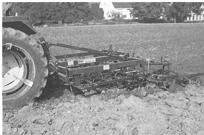
Abb. 4: Mit der Federzinkenegge, dem Standardgerät, werden oft zwei Arbeitsgänge benötigt. Die Abtrocknungsphase zwischen den Durchgängen muss so bemessen sein, dass der Boden an den natürlichen Bruchstellen zerfällt (Vermeidung des «Toteggens»).
