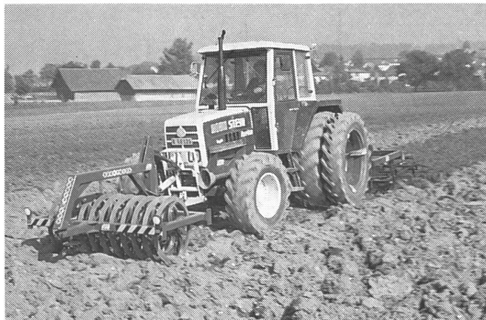
Abb. 3: Je nach Konstruktion und Eigengewicht bewirkt der Frontpacker nebst dem Zerkleinern und Auebnen des unbefahrenen Bodens zwischen den Traktorrädern einen gewissen Druck in die Tiefe (Ringpacker, links) oder nur oberflächlich (Spiralpacker, rechts). Dieser Druck kann mit einem doppelwirkenden Hydraulikzylinder verstärkt werden. Der Hubkraftbedarf der Fronthydraulik entspricht etwa dem 1,5-fachen Packergewicht.
