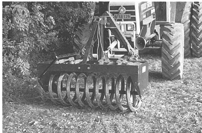
Abb. 3: Je nach Konstruktion und Eigengewicht bewirkt der Frontpacker nebst dem Zerkleinern und Auebnen des unbefahrenen Bodens zwischen den Traktorrädern einen gewissen Druck in die Tiefe (Ringpacker, links) oder nur oberflächlich (Spiralpacker, rechts). Dieser Druck kann mit einem doppelwirkenden Hydraulikzylinder verstärkt werden. Der Hubkraftbedarf der Fronthydraulik entspricht etwa dem 1,5-fachen Packergewicht.
