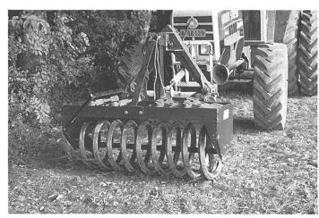
Abb. 3: Je nach Konstruktion und Eigengewicht bewirkt der Frontpacker nebst dem Zerkleinern und Ausebnen des unbefahrenen Bodens zwischen den Traktorrädern einen gewissen Druck in die Tiefe (Ringpacker, links) oder nur oberflächlich (Spiralpacker, rechts). Dieser Druck kann mit einem doppelwirkenden Hydraulikzylinder verstärkt werden. Der Hubkraftbedarf der Fronthydraulik entspricht etwa dem 1,5-fachen Packergewicht.
