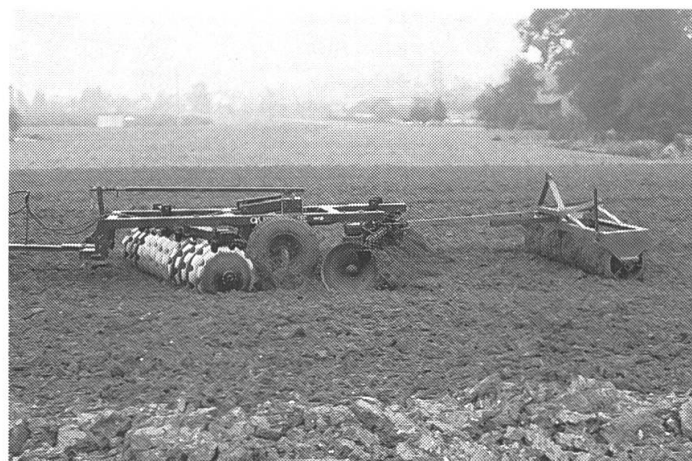
Abb. 5: Die Saatbettbereitung mit der Scheibenegge und kombinierter Rauhwalze ist unüblich, aber möglich. Bei fehlender Bodenbedeckung schützen die groben Schollen vor Wasser und Wind.
