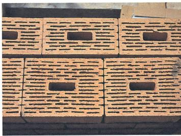
OPTITERM – eine neue Backsteingeneration mit besserer Wärmedämmung.
