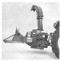
Kurzhacker 5-25 mm. Hackschnitzelmaschine für automatische Heizanlagen.
