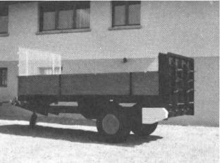
Vier stehende Fräswalzen. Breite Streumöglichkeit. Stahlbordwände 50 cm. Schutzgitter. Gelenkwelle. Farmerstopbremse. Beleuchtung. Kratzboden vor- und rückwärtslaufend. Hintere Stahlbordwand. Die Maschine ist auch mit zwei liegenden Fräswalzen lieferbar. Die Zettaggregate sind an beiden Maschinen in fünf Minuten zu demontieren und schon steht Ihnen ein Anhänger mit Kratzboden zur Verfügung.
