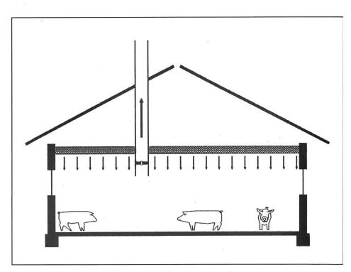
Abb. 1: Prinzip der Stallüftung mit Lüftungsdecken (Unterdruck).
