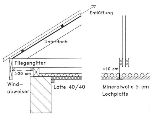
Abb. 5: Traufausbildung eines Lüftungsdaches für eine Lochdecke mit Windabweiser und Fliegengitter.
