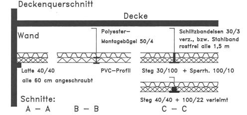
Abb. 4: Abhängung der Lüftungsdecken mit T-Profilen aus Holz unter bestehenden Decken aus Holz oder Beton.
