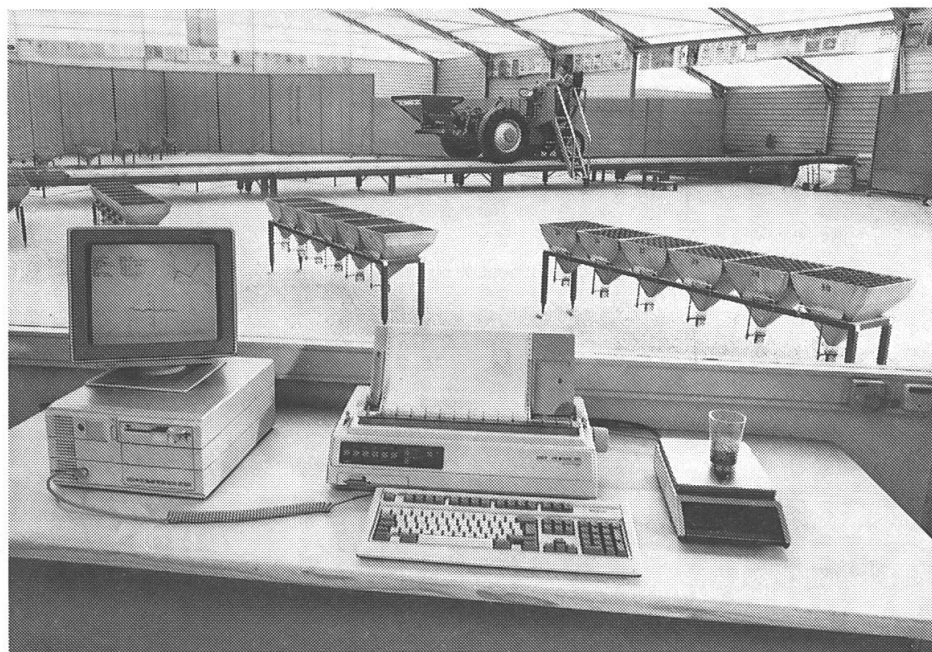
Blick in die Düngerstreuer-Prüfhalle. Im Mittelgrund ist der Elektrotraktor an der Führungsschiene erkennbar.
