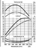
momentanstieg von bis zu 26 %. Neu: Bei sinkender Motordrehzahl fällt die Leistung nicht ab, sondern bleibt bis 1850 U/min auf konstant hohem Niveau.
