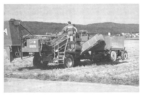
d) Wühlmaus 1733 CH war der grösste Vertreter der Vollernter in den Vergleichsversuchen. Er ist wie der Wisent mit einem 3fach-Rotorabstreifer ausgerüstet. Der Importeur, **Messer AG, Niederbipp SO,** hat den 1733 CH durch den 1750 CH, einem neuen Modell der gleichen Bauart, abgelöst.
