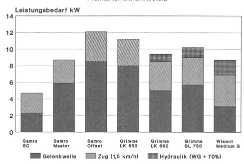
Abb. 6: Leistungsbedarf. Unter «Hydraulikleistung» ist die übertragene Hydraulikleistung des Traktors (Wirkungsgrad 70 %) zu verstehen.
