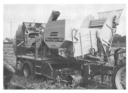
a) Samro Offset mit Zusatzbehälter am Rollbodenbunker für Klein- und Ausschussknollen. Aus dem Hause **Samro Bystronic, Burgdorf,** wurden ausserdem die Vollernter Samro SC und der Samro Master geprüft.
