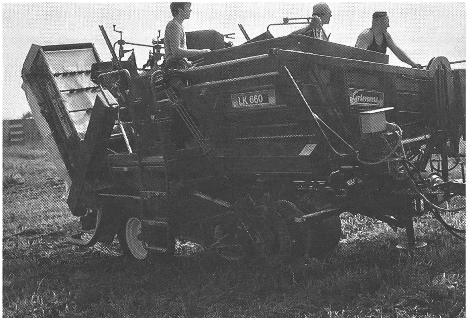
b) Der Grimme LK 660 ist ein Vollernter mit Seitendammaufnahme und symmetrischer Siebbandanordnung in zweistöckiger Bauweise. Von Grimme, in der Schweiz vertreten durch Grunder SA, Lucens VD , wurden auch der LK 650 und der SL 750 getestet.
