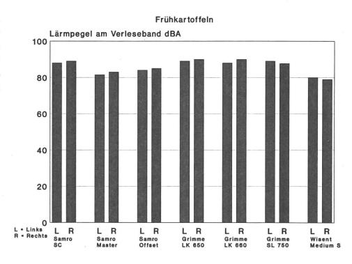
Abb. 2: Lärmpegel links und rechts am Verleseband auf Ohrhöhe gemessen. Die Siebkänäle waren bei keiner Maschine mittels Planen abgedeckt.
