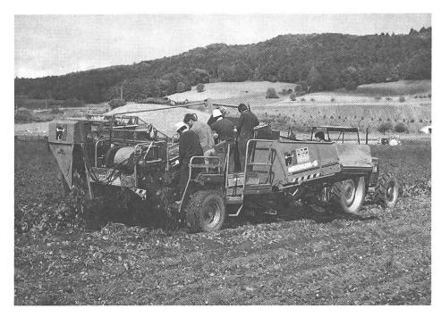
c) Der Wisent Medium S ist ein Vollernter mit Seitenaufnahme in einstöckiger Bauweise. Als Neuerung wird bei diesem Fabrikat – es wird von **Müller Maschinen AG, Bättwil BL,** importiert – das Sammeln der Klein- und Ausschusskartoffeln im Rollbodenbunker integriert.
