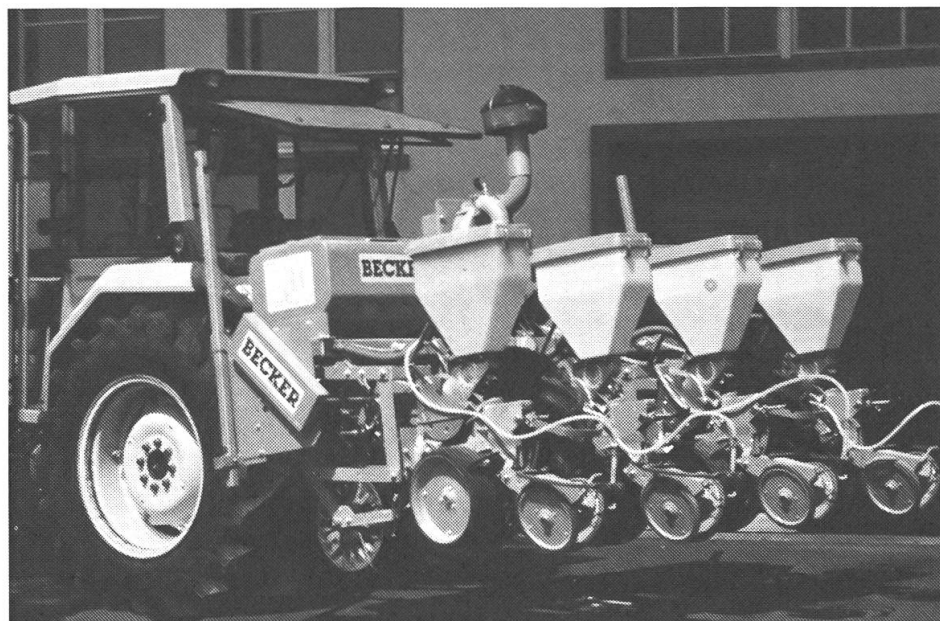
Abb. 8: Diese schwere Einzelkornsämaschine mit Scheibensech, Doppelscheibenschar mit Tiefenführungsradern und V-förmigen Druckrollen lässt sich vielseitig für Direkt- und Mulchsaat, Saat in die rauhe Pflugfurche und Normalsaat einsetzen.
