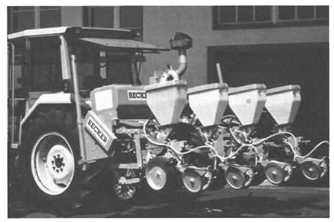
Abb. 8: Diese schwere Einzelkornsämaschine mit Scheibensech, Doppelscheibenschar mit Tiefenführungsrädern und V-förmigen Druckrollen lässt sich vielseitig für Direkt- und Mulchsaat, Saat in die rauhe Pflugfurche und Normalsaat einsetzen.
