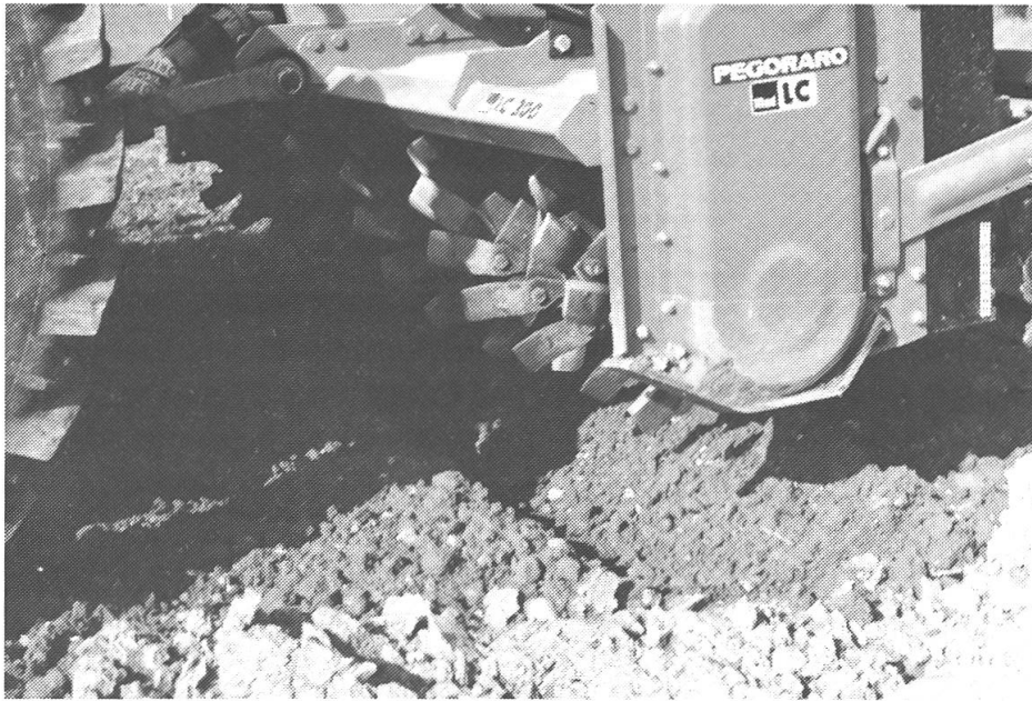
Abb. 4: Der Zinkenrotor hat sich für das Zerkleinern und Einarbeiten üppiger Pflanzenbestände (Gründüngung, Durchwuchs, Unkräuter) bestens bewährt.
