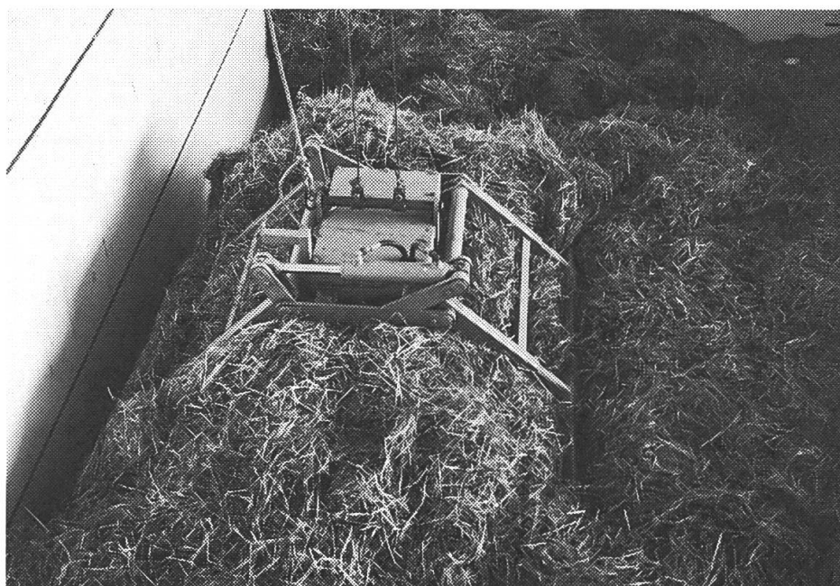
Abb. 1: Auch Kurzschnitt kann mit dem Greifer problemlos ein- und ausgelagert werden.
