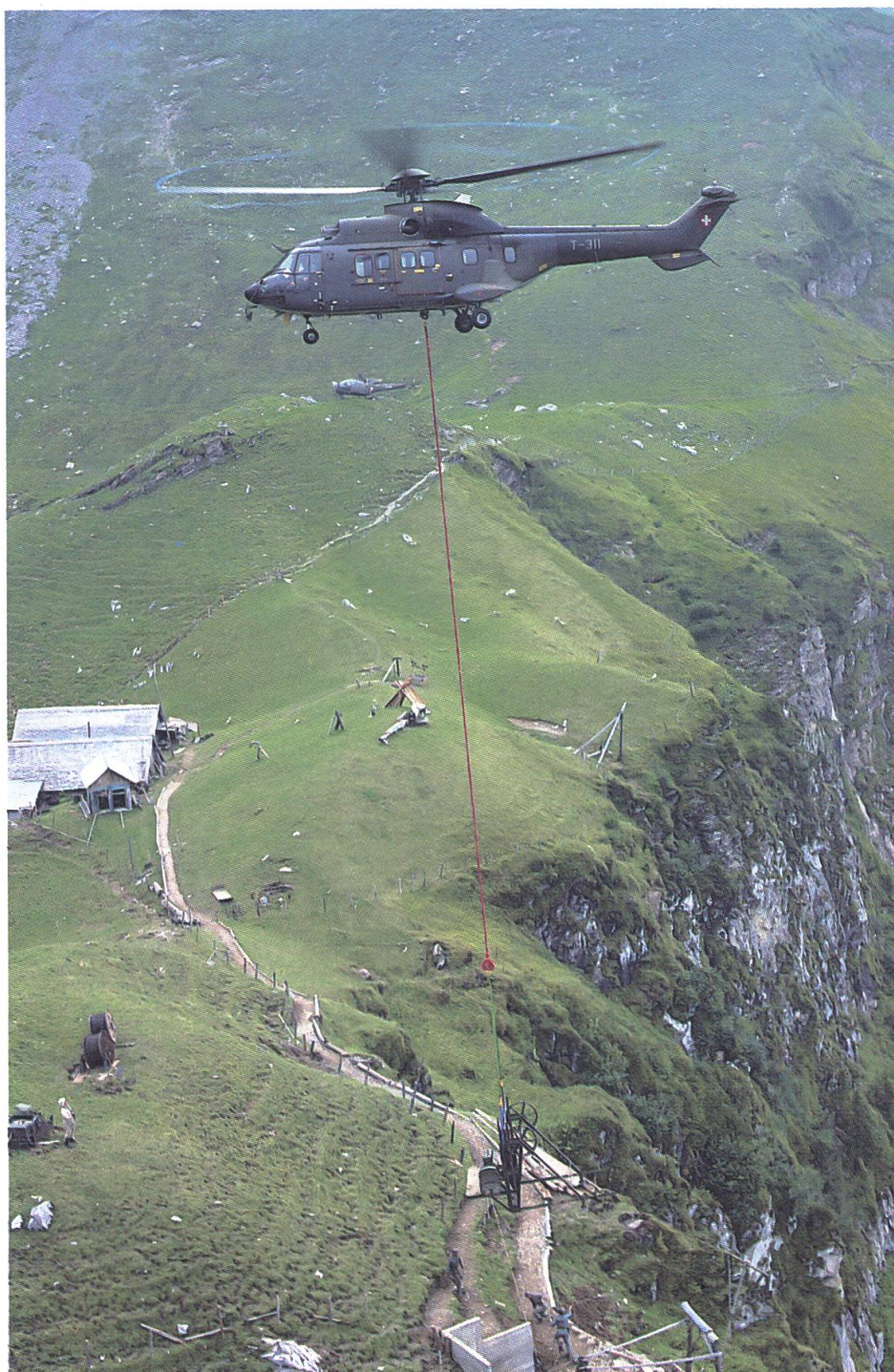
Ein Super-PUMA bringt das 2,5 Tonnen schwere Aggregat zur Bergstation.
