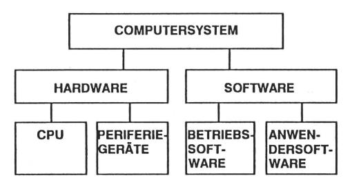
Mit Hardware bezeichnet man alle Geräte, die zu einem Computersystem gehören. Dazu rechnet man den zentralen Teil, die CPU (Central processing unit) mit dem Haupt- und Arbeitsspeicher sowie die Periferiegeräte (Drucker, Bildschirm, Tastatur etc.).
