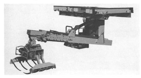
Vollhydraulischer Hängedrehkran (Einfach- und Doppelteleskop, mit oder ohne Seilabtrieb) im Baukasten-System
