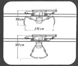
Hallenlaufkran KIWA-Elektrolift 2 TR-S, optimale Raumausnützung und Zwei-Waben-Trägerbrücke, Hydraulikgreifer, Traglast 1500 kg, Hubgeschwindigkeit 15 und 30 m/min.
