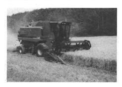
Durch den Vierradantrieb wurde die Geländegängigkeit der Axial-Flow-Mähdrescher, die mit zwei verschiedenen Bereifungsgrössen (30,5-32 oder 24,5-32) lieferbar sind, noch einmal verbessert, so dass die Arbeit auch in schlechtem Terrain ermöglicht wird. **Rohrer Marti AG, Dällikon**
