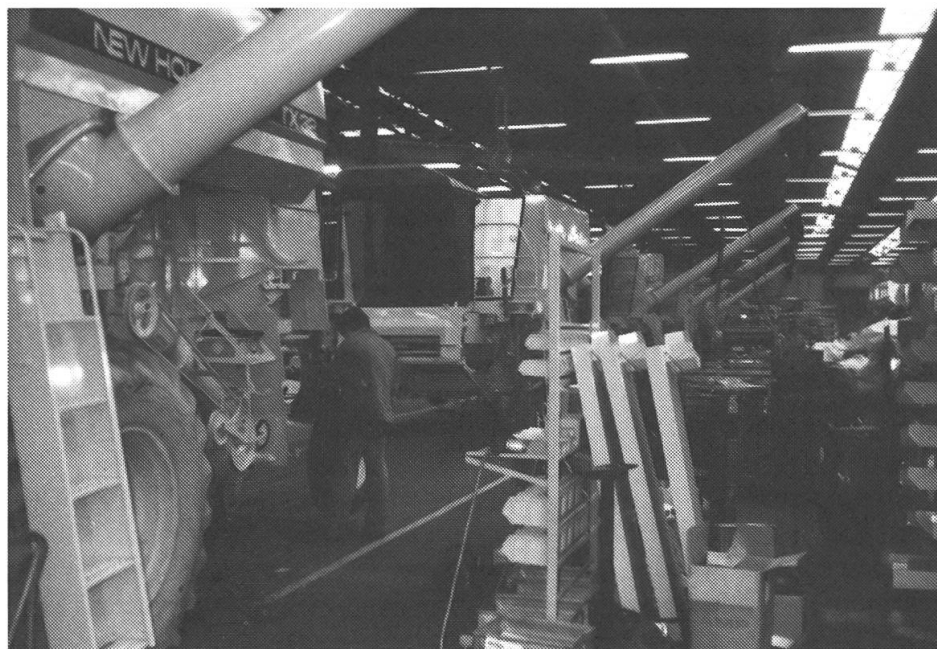
Jährlich verlassen 6000 Mähdrescher die Werke im belgischen Zedelgem. Auf dem Foto: Endmontage der Mähdrescher.
