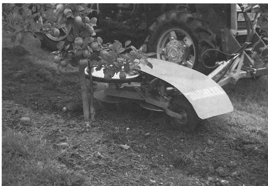
Bücheler Krümelmaschine BN2. Ein Tastrad führt die 2. Hackscheibe um die Stämmchen herum.
