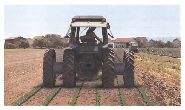
Reihen Doppelspur-Räder für Hack- und Pflegearbeiten, mit jeder gewünschten Zwischenbreite.
