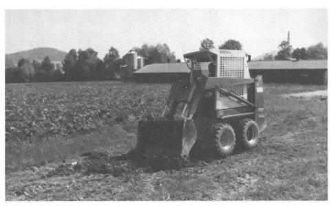
Abb. 8: Bei Grab- und Erdarbeiten sind Baggerzähne von Vorteil. Bei hartem Grund erweist sich das relativ kleine Maschinengewicht als Nachteil.
