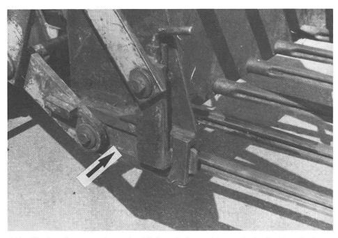
Abb. 10: Das System mit zwei seitlichen Anbauschienen ist in der Handhabung etwas umständlich, da die Schienen relativ genau in die Führung am Arbeitsgerät eingeführt werden müssen.
