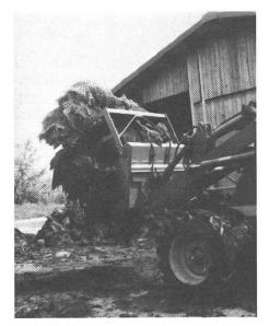
Abb. 7: Der Gegengreifer an der Mistgabel (Krokodilzange) erlaubt eine bessere Füllung und hält den Mist auf dem Weg zum Mistzetter fest.
