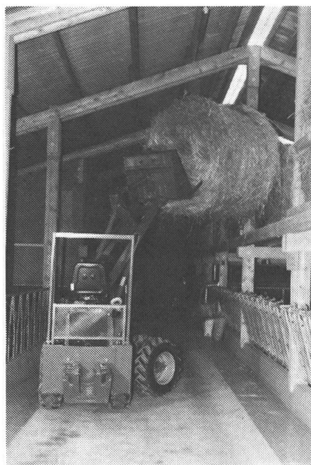
Abb. 6: Ein Hoftransporter mit Knicklenkung beschickt eine Zwischenbühne von der Futterdurchfahrt aus mit einer Rundballe. Bei Hebe- und Ladearbeiten mit Knicklenkern reduziert die Doppelbereifung die seitliche Umsturzgefahr.
