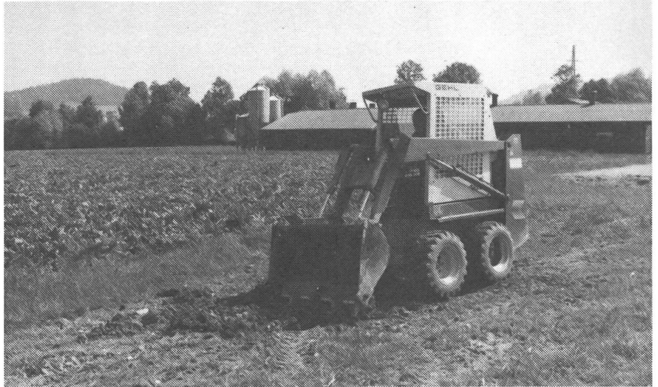
Abb. 8: Bei Grab- und Erdarbeiten sind Baggerzähne von Vorteil. Bei hartem Grund erweist sich das relativ kleine Maschinengewicht als Nachteil.
