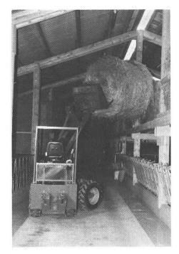
Abb. 6: Ein Hoftransporter mit Knicklenkung beschickt eine Zwischenbühne von der Futterdurchfahrt aus mit einer Rundballe. Bei Hebe- und Ladearbeiten mit Knicklenkern reduziert die Doppelbereifung die seitliche Umsturzgefahr.
