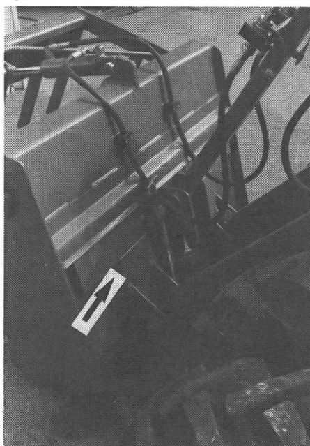
Abb. 9: Ein Anbaurahmen mit Verriegelung erleichtert den schnellen Gerätewechsel.
