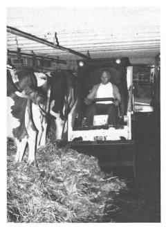
Abb. 5: Kompaktlader beim Entmisten eines Anbindestalles. Hier zählt vor allem die Arbeitserleichterung. Geeignet sind Ställe mit flacher Kotplatte. Breite Türen und eine «Anstossplatte» am Ende der Kotplatte sind von Vorteil.
