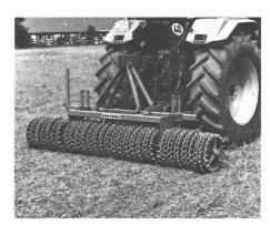
die Walzen mechanisch oder hydraulisch eingeklappt werden. Die Walzendurchmesser betragen 45 oder 50 cm. Alle Walzen werden serienmässig mit hochfesten, verschleissunempfindlichen Flanschlagern ausgerüstet. Die Dreipunktanbauwalzen sind sehr kurz gebaut. Dies sorgt für
