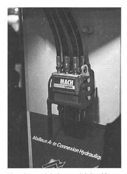
Kupplungseinheit, um gleichzeitig 5 hydraulische- und 6 elektrische Verbindungen herzustellen.
