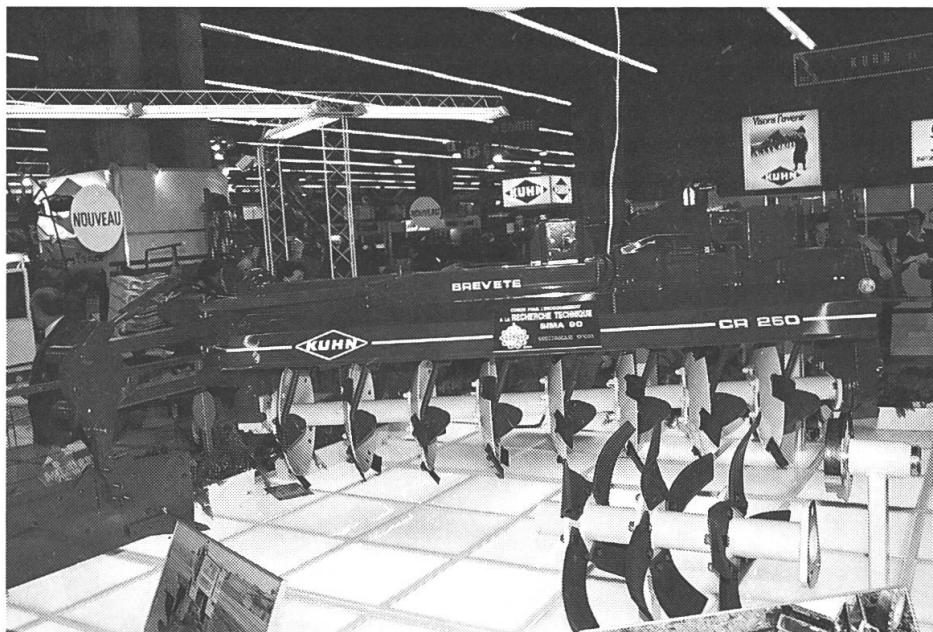
«Rotor-Pflug» - Dank dem Antrieb des Rotors über die Zapfwelle kann trotz grosser Arbeitsbreite (bis 2,5 Meter) ein relativ leichter Traktor eingesetzt werden, ohne mit Schäden durch Schlupf oder Durchdrehen der Räder rechnen zu müssen.
