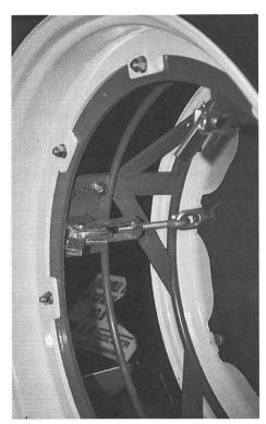
Die rasche und betriebssichere Montage der Doppelbereifung unterstützt die Empfehlung, wo immer möglich diese für Feldarbeiten auch einzusetzen.
