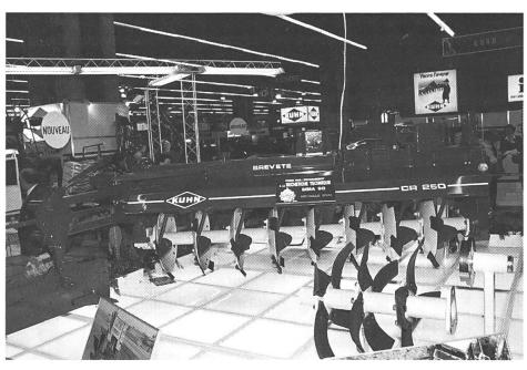
«Rotor-Pflug» - Dank dem Antrieb des Rotors über die Zapfwelle kann trotz grosser Arbeitsbreite (bis 2,5 Meter) ein relativ leichter Traktor eingesetzt werden, ohne mit Schäden durch Schlupf oder Durchdrehen der Räder rechnen zu müssen.
