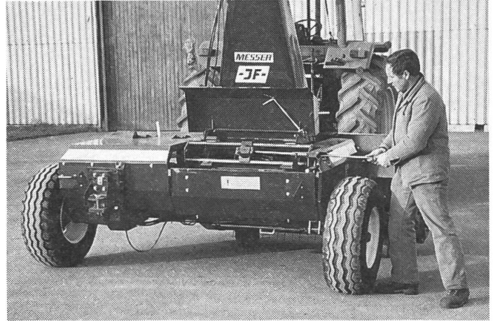
Abb. 7: Das Schleifen der Messer und das Nachstellen des Messerrades ist beim Scheibenradhäcksler (links) einfacher als beim Trommelradhäcksler (rechts).
