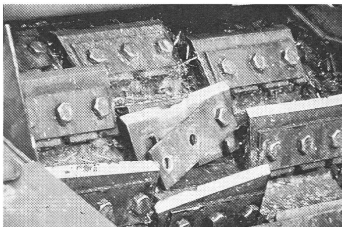
Abb. 3: Links: Scheibenrad mit durchgehenden Messern. Rechts: Trommelrad. Bei der Segmentmessertrommel (Vielmessertrommel) ist der Schaden durch einen Fremdkörper (Steine oder Metall) weniger gross als bei dem Scheibenrad mit durchgehenden Messern.
