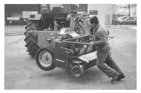
Abb. 1: Das Umschwenken erfordert vom Traktorfahrer einiges Können und Routine. Die Arbeit muss unbedingt in der richtigen Reihenfolge ablaufen.
