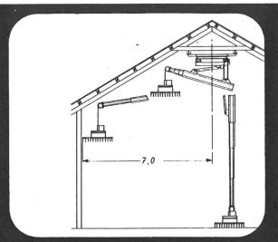
Hängedrehkran KIWA-Hydrofix 3 V-H mit dreifachem hydr. Teleskopausleger, Hydraulikgreifer an zwei getrennten Lastseilen, max. Traglast 1000 kg, Hubgeschwindigkeit 30 m/min.
