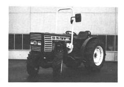
Zur Erhöhung des Fahrkomforts wurden die Gangschalthebel nach vorne versetzt und die hydraulischen Steuergeräte sind neu seitwärts angeordnet. Dadurch wird nicht nur der Einstieg erleichtert, sondern auch mehr Platz für den Fahrer geschaffen. Das Steuerrad ist neu höhenverstellbar und kann sich somit ergonomisch der Grösse des Fahrers anpassen, zudem ist der neue Komfortsitz höhenund längsverstellbar.
