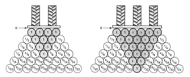
Abb. 3: Druckfortpflanzung bei gleichem Kontaktflächendruck K und unterschiedlichem Gewicht. Je grösser das Gewicht, um so grösser die Tiefenwirkung.
