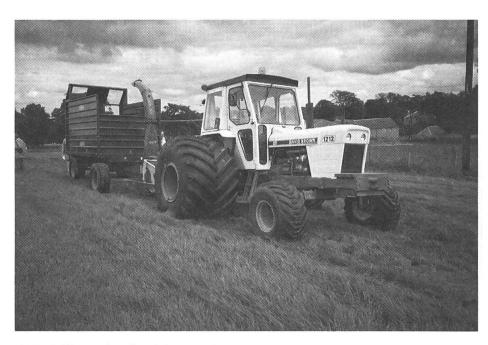
Abb. 1: Wenn eine Gewichtszunahme unumgänglich ist, so muss die Bereifung überproportional anwachsen.
