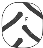
Abb. 2: Der spezifische Bodendruck bzw. Kontaktflächendruck K = G : F ist nur ein Mass für die Verdichtungsgefahr an der Oberfläche.
