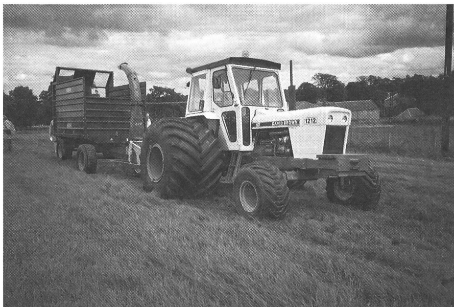
Abb. 1: Wenn eine Gewichtszunahme unumgänglich ist, so muss die Bereifung überproportional anwachsen.
