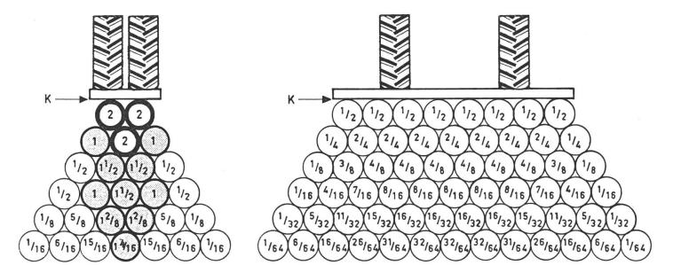
Abb. 4: Minimale Druckfortpflanzung bei gleichem Gewicht und unterschiedlicher Aufstandsfläche, das heisst Bereifung.
