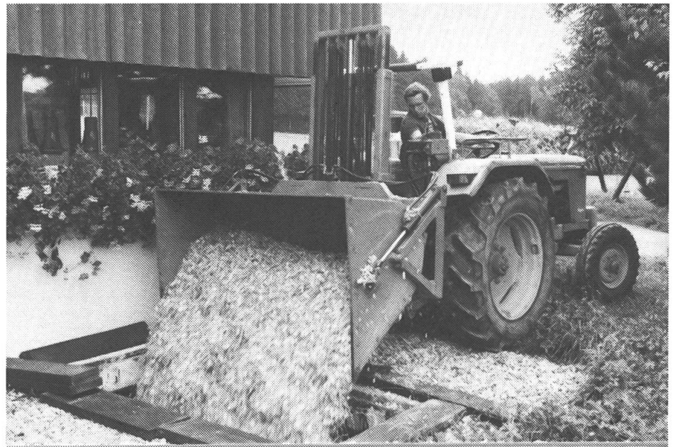
Abb. 19: Heckstapler mit Kippmulde beim Befüllen eines Holzschnitzel-Bunkers.
