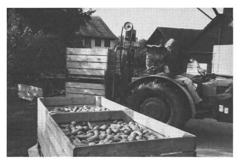
Abb. 1: Heckstapler beim Umschlag von Obstkisten.
