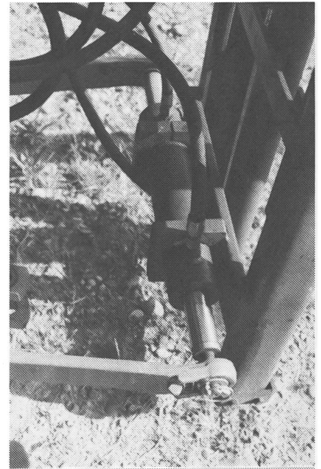
Abb. 5: Seitenschub-Vorrichtung (bei diesem System wird der ganze Heckstapler in bezug auf die Dreipunktaufhängung verschoben).
