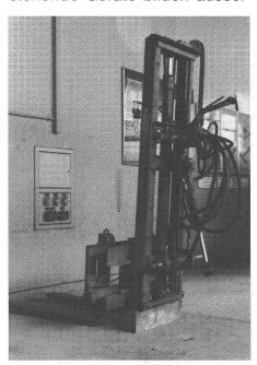
Abb. 15: Das geordnete, sichere Abstellen des Gerätes ist Voraussetzung für das mühelose Ankuppeln im Einmannsystem und hilft Unfälle vermeiden.
