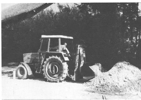
Abb. 3: Hecklader mit Erdschaufel.
