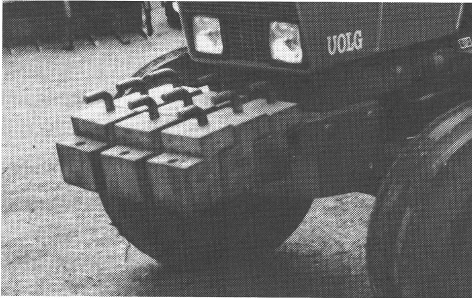
Abb. 13: Eine ausreichende Belastung der Frontachse ist für die Erhaltung der Lenkfähigkeit entscheidend.
