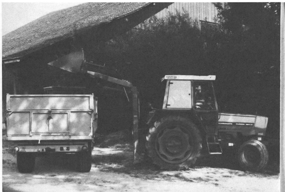
Abb. 21: Hecklader mit Erdschaufel beim Kiesladen.
