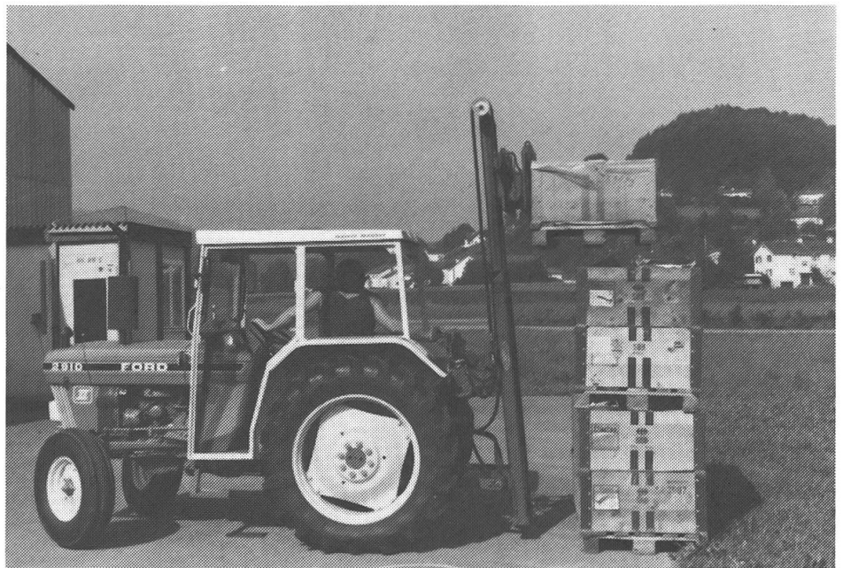
Abb. 17: Heckstapler beim Stapeln von Paloxen.
