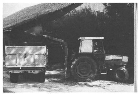
Abb. 21: Hecklader mit Erdschaufel beim Kiesladen.
