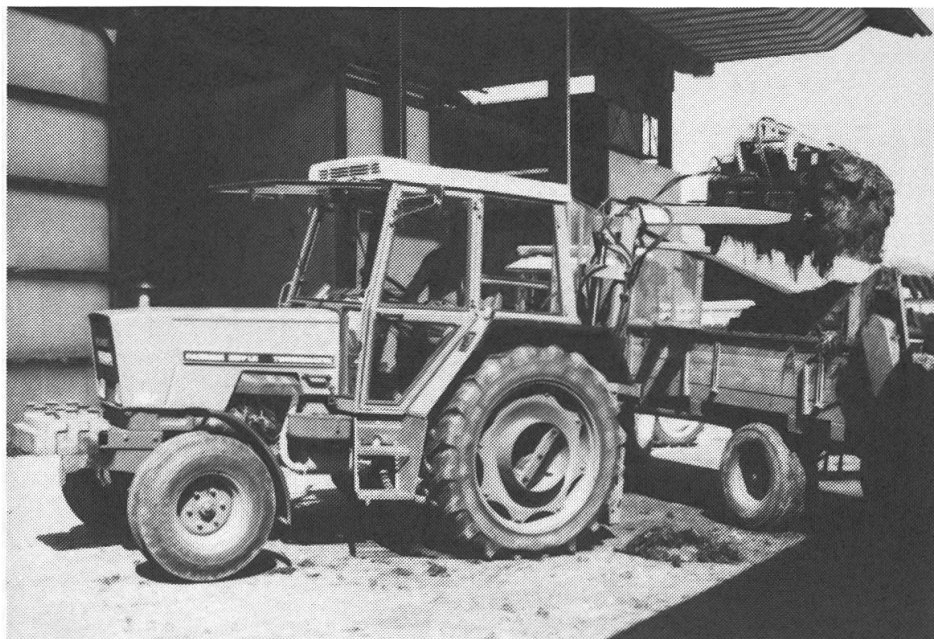
Abb. 20: Hecklader mit Krokodil-Zange beim Ausmisten eines Laufstalles.
