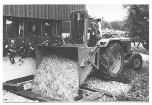
Abb. 19: Heckstapler mit Kippmulde beim Befüllen eines Holzschnitzel-Bunkers.
