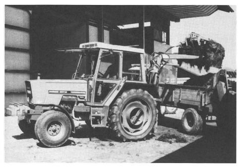
Abb. 20: Hecklader mit Krokodil-Zange beim Ausmisten eines Laufstalles.
