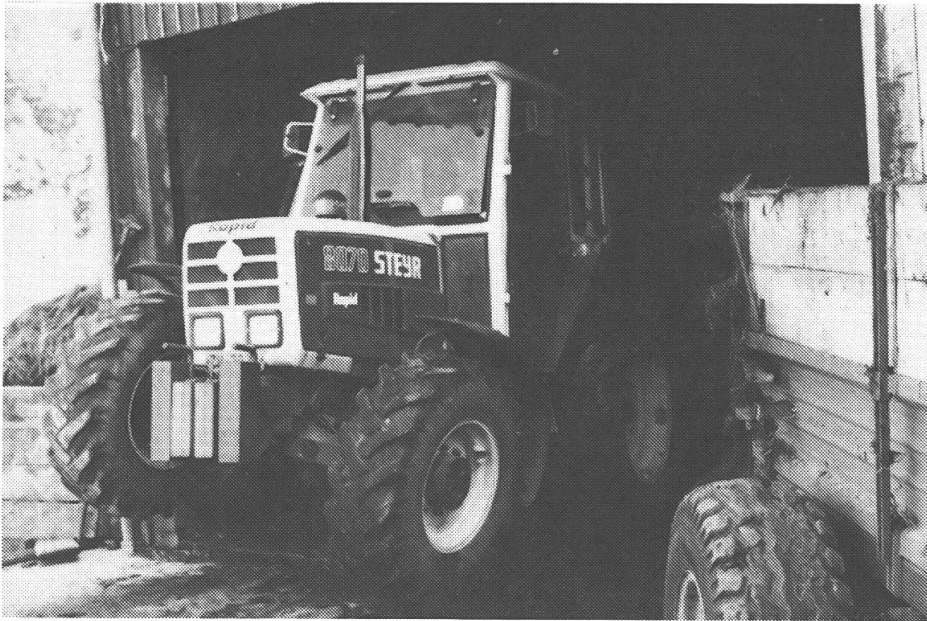
Abb. 10: Die Hubkräfte sind meist durch das Abheben der Frontachse, das heisst durch die Gewichtsverhältnisse am Traktor begrenzt.
