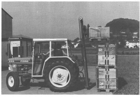
Abb. 17: Heckstapler beim Stapeln von Paloxen.
