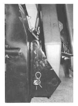
Abb. 16: Schnellwechselrahmen erleichtern das An- und Abkuppeln verschiedener Werkzeuge wesentlich.
