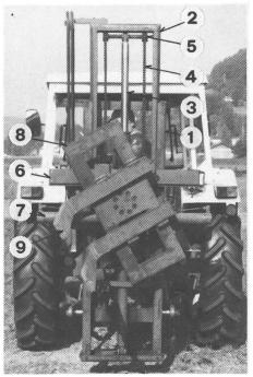
Abb. 6: Heckstapler mit Gabeldrehvorrichtung
