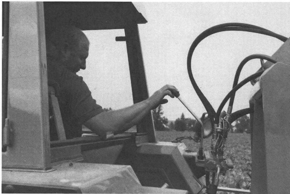
Abb. 7: Der Ventilblock ist in der Regel auf der dem Fahrer zugewandten Seite des Staplers montiert.
