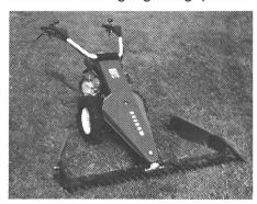
niert und leicht zu bedienen. Besonders vorteilhaft ist das Umschalten auf Rückwärtsfahrt des jeweils eingelegten Ganges. Typische technische Details wie der *Reform-*Zahnkurbelmähantrieb, leichtes Trennen des Mähwerkes vom Triebwerk und leistungsstarke Zwei- und Viertaktmotoren mit 8 PS zeichnen den neuen *Reform 216* aus.
