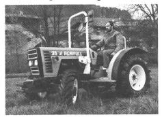
tenschaltung, hydraulische Lenkung, verschleissfreie, nasse Scheibenbremsen im Ölbad, lastschaltbare 540/1000 und Wegzapfwelle inkl. 2 Steuergeräte mit vier Hydraulikanschlüssen. Planetenvorderachse mit 50° Einschlag, Fronthydraulik und Frontzapfwelle auf Wunsch lieferbar. Der leistungsfähige *Agrifull 35 DT* mit der modernen Technik der «Grossen» weist ein Gesamtgewicht von nur 1400 kg auf.
