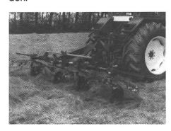
Die Konstruktion erlaubt den Frontmähknickzetter bereits mit verhältnissmässig leichten Traktoren einzusetzten. Der Schwad wird auf 1,15 m Breite abgelegt, bleibt also innerhalb der Traktorspur. Eine Kombination von Front- und Heckmähwerk erreicht eine Arbeitsbreite von bis zu 4,75 m.
