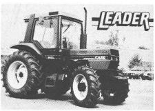
vor. Die Modelle Case-IH 633 (52 PS) und 833 (67 PS) sowie die Komforttraktoren 685 (68 PS) und 885 (78 PS), die 844-AXL (80 PS), 856-AXL (85 PS) werden mit dem Leader-Paket ausgerüstet. Dieses Paket wird zu einem absoluten Sonderpreis angeboten und umfasst Sonderausrüstungen, wie zum Beispiel: hydraulische Anhängerbremse, höhenverstellbare Anhängevorrichtung, Schnellkuppler an der Dreipunktaufhängung, zusätzli-
