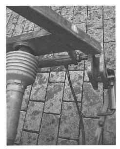
Der Schnellkuppler von Steiner in Ardagger, Österreich, erlaubt das automatische An- und Abkuppeln der Anbaugeräte an der Front- bzw. Heckhydraulik. Nach dem Anheben des Gerätes durch den Oberlenker findet die Kupplung der Gelenkwelle und die Einrastung und hydraulische Verriegelung der Unterlenker statt.
