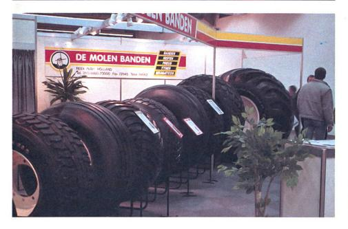
Die Verminderung des spezifischen Bodendrucks dank grossvolumigen Reifen wird ein Verkaufsargument für die Pneu-Hersteller.
