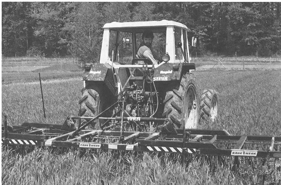
Der Ackerstriegel zur Unkrautregulierung im Getreide ist mit seiner grossen Flächenleistung ein typisches Gerät für den überbetrieblichen Einsatz.
