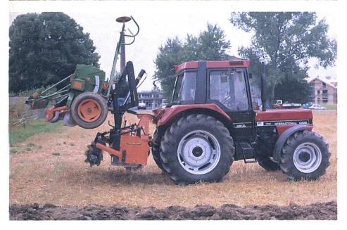
... Ein «grosser» Traktor ist wegen des erheblichen Hubkraftbedarfes an der Hydraulik dennoch erforderlich. Um die Vorderachsentlastung zu begrenzen, wird die Sämaschine für den Transport im «Huckepack» möglichst nahe an die Egge herangehoben.
