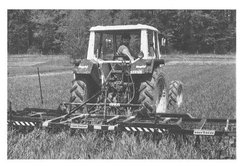
Der Ackerstriegel zur Unkrautregulierung im Getreide ist mit seiner grossen Flächenleistung ein typisches Gerät für den überbetrieblichen Einsatz.
