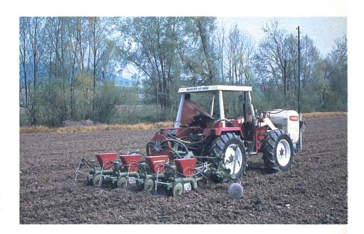
Einzelkornsämaschinen in der Kombination mit der Bandspritzung – wirklich nicht neu, aber aktueller denn je.
