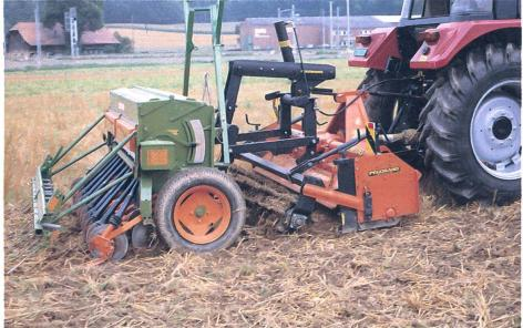
Mit Gerätekombinationen können zwei oder drei Arbeitsgänge in einer einzigen Durchfahrt ausgeführt werden. Der zusätzliche Leistungsbedarf der Sämaschine fällt beim Eggen kaum ins Gewicht...
