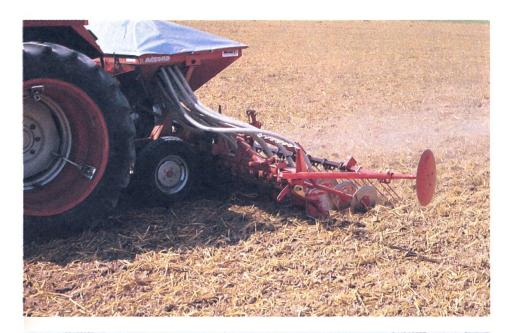
Sämaschinen mit Ein- oder Zweischeibenscharen arbeiten auch, wenn die Pflanzenreste an der Oberfläche verbleiben. Mit der nur oberflächlichen Einarbeitung der Pflanzenreste kann die Verrottung gefördert werden.
