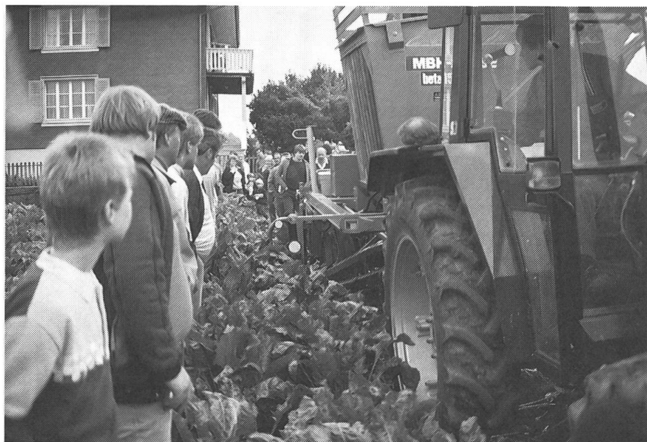
Die Rüben werden am Kraut durch zwei Riemen aus dem Boden gehoben.
