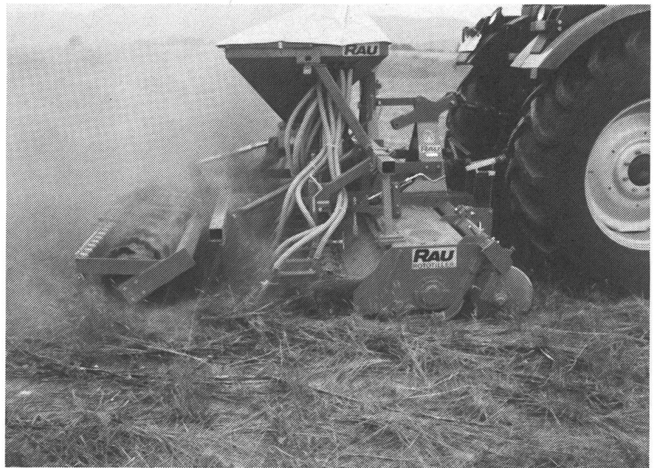
Saat in den Erdstrom ohne Verstopfungsgefahr mit der Rotosem-Bestellsaatmaschine. Die Saatauslaufrohre sind versetzt auf zwei Schienen angeordnet. Der Durchfluss der Ernterückstände wird nicht behindert. Die Samen werden zuverlässig mit Erde bedeckt.
