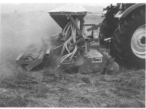
Saat in den Erdstrom ohne Verstopfungsgefahr mit der Rotosem-Bestellsaatmaschine. Die Saatauslaufrohre sind versetzt auf zwei Schienen angeordnet. Der Durchfluss der Ernterückstände wird nicht behindert. Die Samen werden zuverlässig mit Erde bedeckt.
