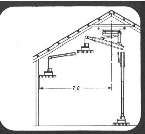
Hängedrehkran KIWA-Hydrofix 3 V-H mit dreifachem hydr. Teleskopausleger, Hydraulikgreifer an zwei getrennten Lastseilen, max. Traglast 1000 kg, Hubgeschwindigkeit 30 m/min.
