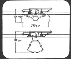
Hallenlaufkran KIWA-Elektrolift 2 TR-S, optimale Raumausnützung und Zwei-Waben-Trägerbrücke, Hydraulikgreifer, Traglast 1500 kg, Hubgeschwindigkeit 15 und 30 m/min.
