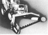
**KURMANN-Frontmähwerk** mit Busatis Doppelmesserschneidwerk 2,5 m
