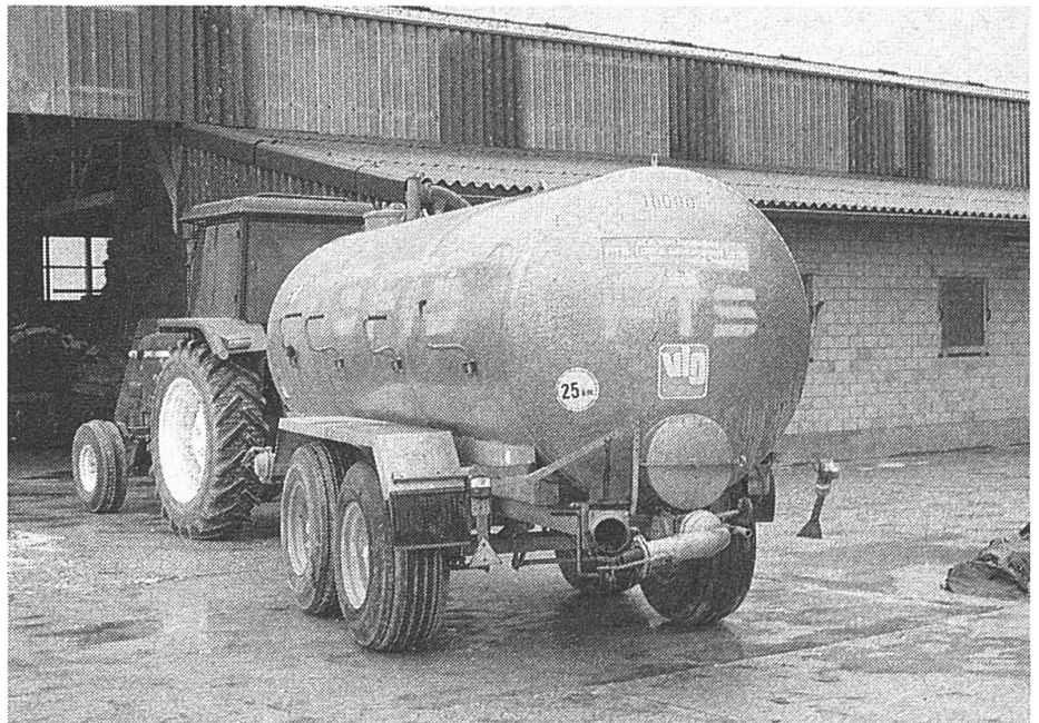
Mit maximal 10'000 Litern Flüssigmist unterwegs. Seit dem 1. Mai 1989 ist dies legal, allerdings nur, wenn das Gesamtgewicht des Tandemanhängers nicht mehr als 12 Tonnen beträgt.
