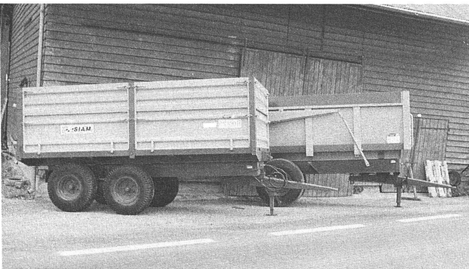
Das Aufbäumen des Traktor kann durch tiefes Anhängen der Einachs- oder Doppelachsanhänger vermindert werden.
