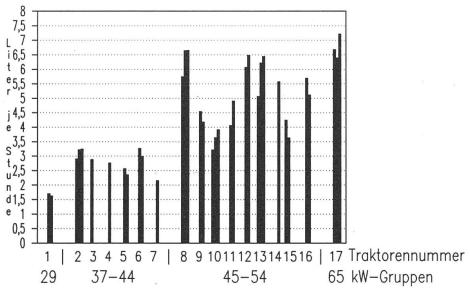
Abb. 4: Dieselölverbrauch je Betriebsstunde bei Traktoren mit 4-Radantrieb
