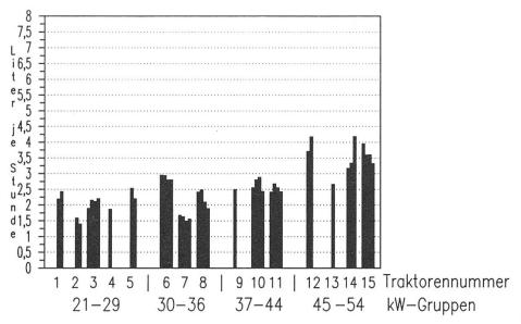
Abb. 3: Dieselölverbrauch je Betriebsstunde bei Traktoren mit 2-Radantrieb
