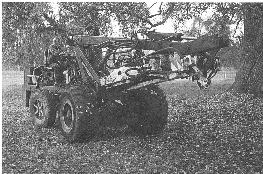
Die schmale und niedere Bauweise machen das knickgelenkte Fahrzeug auch in der Baumanlage beweglich.
