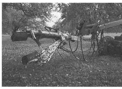
Das rund drei Meter lange Schüttelorgan wiegt fast 800 kg. Mit der hydraulisch regulierbaren Aufhängung wird die gepolsterte Zange optimal an den Baumstamm herangeführt. Der Hydraulikzylinder in der Mitte baut den Anpressdruck auf.
