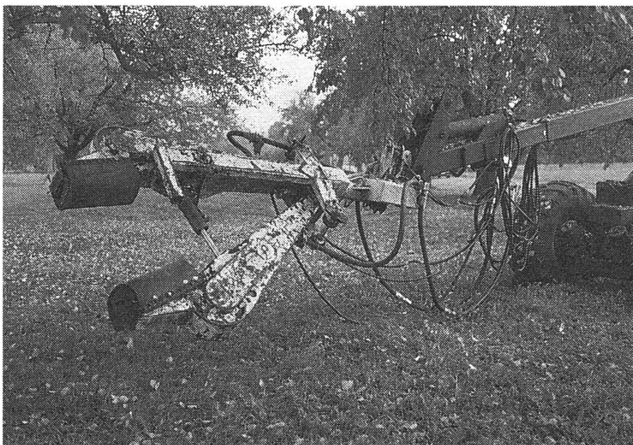
Das rund drei Meter lange Schüttelorgan wiegt fast 800 kg. Mit der hydraulisch regulierbaren Aufhängung wird die gepolsterte Zange optimal an den Baumstamm herangeführt. Der Hydraulikzylinder in der Mitte baut den Anpressdruck auf.
