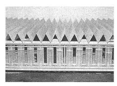
Abb. 1: Mit dem 12-m-Rinnenprüfstand wird die Querverteilung in 10-cm-Abschnitte der Arbeitsbreite getestet. Die 120 Messbecher werden noch mit Strichmarkierungen für einen Sollbereich bzw. die maximalen Abweichungen von  $\pm$  15% versehen.
