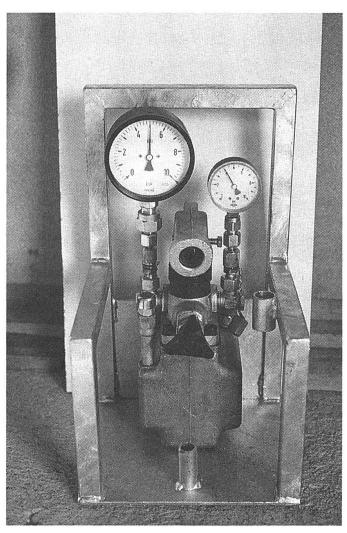
Abb. 3: Die Anzeigegenauigkeit des Manometers der Spritze wird mit einem Eichmanometer an einer Ölpumpe verglichen. Defekte Manometer sollen am Prüfort durch neue ersetzt werden.
