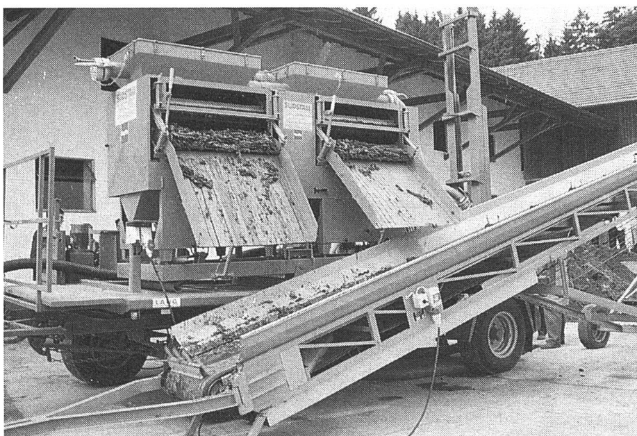
Abb. 2: Siebtrommelpresse (mobile Anlage).
