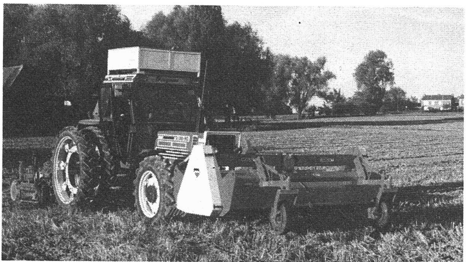
Moreau: Dieser Blatthäcksler steht gegenwärtig bei der Zuckerrüben-ernte ohne Blattbergung in der Felderprobung. Er arbeitet mit einem sehr schnell laufenden Rotor, der das Rübenblatt extrem fein zerschlägt und über Leitbleche zwischen den Rübenreihen ablegt. Die Maschine wird an der Agritechnica erstmals der Öffentlichkeit gezeigt.
