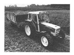
linder-Turbomotor und ein Vollsynchron-Wendegetriebe. Das Gangangebot umfasst 16 Vor- und 8 Rückwärtsgänge. Auf Wunsch wird die Maschine mit Vierfach-Spar-Zapfwelle, mit Stationär-, Mäh- und Frontzapfwelle komplettiert. Eine unter Last schaltbare und zentral angetriebene Lenktriebachse mit integriertem Lenkzylinder gehört ebenso zum Ausrüstungsstandard wie eine hubstarke Regelhydraulik.
