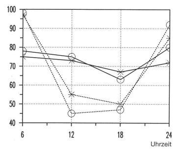
Abb. 8: Verlauf der relativen Luftfeuchtigkeit innen und aussen von zwei Sonnentagen (Kälberstall, 1. Winter).
