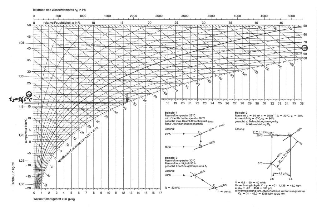
Abb. 5: h, x-Diagramm für feuchte Luft für p = 950 mbar, H = 540 m ü. M., auch Mollierdiagramm genannt, [6]. Als Beispiel ist die Taupunkt-Temperatur zu 20° C bei 80% relativer Luftfeuchtigkeit 16,5° C.
