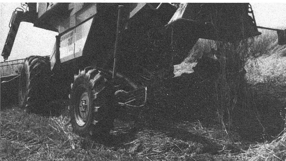
Hangmähdrescher mit nachgerüstetem Allradantrieb.
