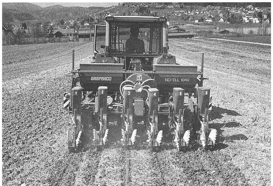
Abb. 8: Bei der Streifenfrässaat wird das Saatgut in knapp 10 cm breite Streifen abgelegt. Unter feuchten Bodenbedingungen können sich die Winkelmesser nachteilig auswirken.
