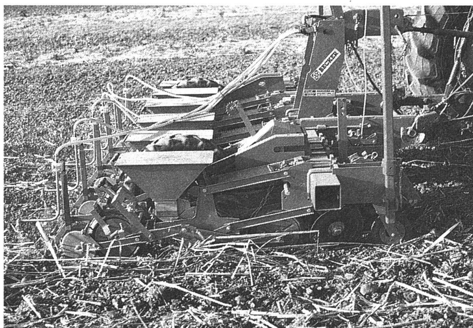
Abb. 11: Direktsaat-Zusatzaggregate (Tastrap, Räum-, Zudeckscheiben, Druckrolle) für herkömmliche Einzelkornsämaschinen, 6-reihig, verursachen Mehrkosten von zirka Fr. 3000.—.
