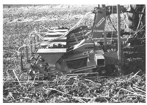
Abb. 11: Direktsaat-Zusatzaggregate (Tastrad, Räum-, Zudeckscheiben, Druckrolle) für herkömmliche Einzelkornsämaschinen, 6-reihig, verursachen Mehrkosten von zirka Fr. 3000.-.
