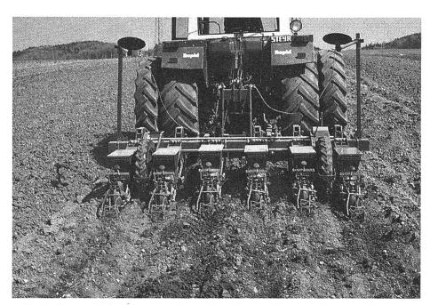
Abb. 10: Saat mit abgeänderter Einzelkornsämaschine (vgl. Abb. 11) direkt in die Pflugfurche, mit der gleichwertige Erträge erzielt werden können. Zur Erleichterung der Pflege- und Erntearbeiten ist gleichzeitiges Ausebnen der Oberfläche unerlässlich.
