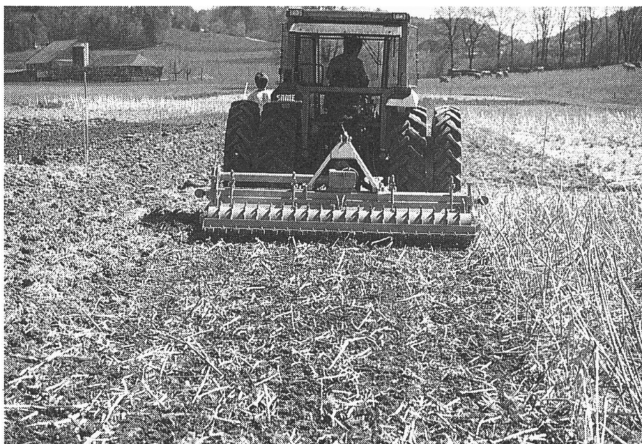
Abb. 3: Das Einarbeiten von abgefrorenen Sonnenblumen mit dem Zinkenrotor gewährleistet eine verstopfungsfreie Einzelkornsaat.
