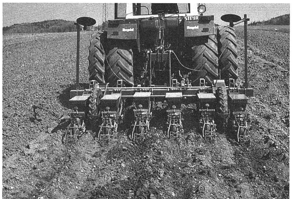
Abb. 10: Saat mit abgeänderte Einzelkornsämaschine (vgl. Abb. 11) direkt in die Pflugfurche, mit der gleichwertige Erträge erzielt werden können. Zur Erleichterung der Pflege- und Erntearbeiten ist gleichzeitiges Auebnen der Oberfläche unerlässlich.
