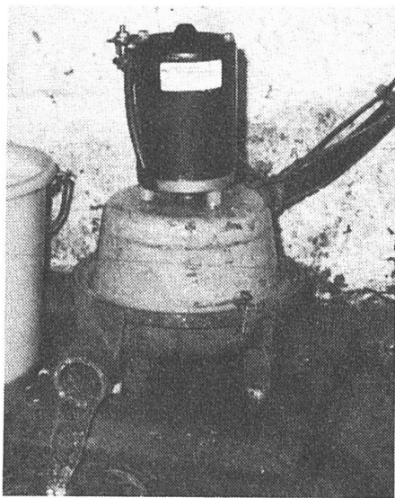
Abb. 3: Kleinst-Pelton turbine mit aufgebautem Gleichstrom-Generator. (Die Turbine der Blackenalp ist bei etwa gleicher Grösse mit drei Düsen ausgestattet.)
