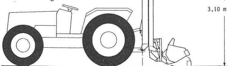
Verwindungsfeste Doppelrahmen-Konstruktion erlaubt gute Sicht auf die Werkzeuge.
