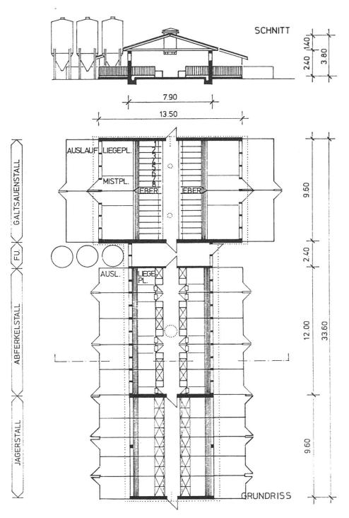
Abb. 9: Artgemäss gestalteter Schweinezuchtstall mit Vierflächenbuchten für tragende Sauen, Abferkelbuchten für frei sich bewegende Muttertiere und Dreiflächenbuchten für die abgesetzten Ferkel (7).
