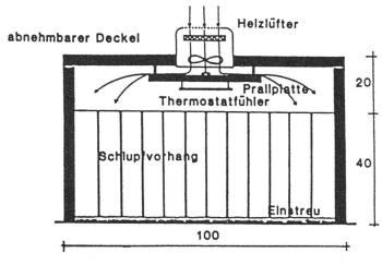
Abb. 2: Längsschnitt durch ein mit einem thermostatisch gesteuerten Heizlüfter klimatisiertes Ferkelnest.
