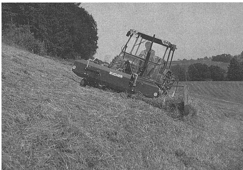
Der Bandrechen in unterschiedlicher Dimensionierung (im Bild vor einem Bucher Polytrac) ist eine valable Alternative zum Kreiselschwader.
