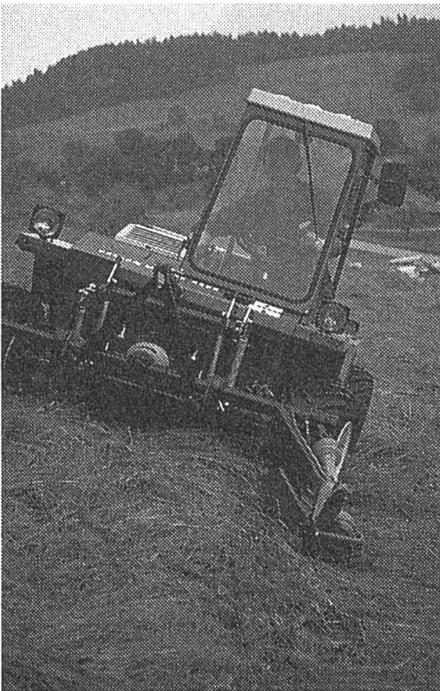
Bestechend gute Arbeit mit Zweiachs- mäher und Busatis. Die Gegenlenkung bei Fahrt in der Schichtenlinie war auch mit diesem Fahrzeug unerlässlich.
