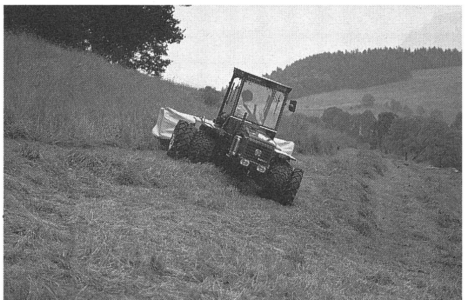
Gute Fahrt des Carraro mit Rückfahreinrichtung. Die Schräglage zur Schichtenlinie ist als Folge der Hinterachslenkung (in Arbeitsstellung) unvermeidlich.
