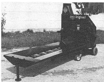
Der bekannte österreichische Hersteller EBERL bringt diese Saison einen neuen, modernen und sehr leistungsfähigen Abladehäcksler, den ORIGIN 2860-H Comfort. Er hat das praktische Hydro-Getriebe und einen tiefen, hochklappbaren Einlegetrog, auf Wunsch eine Untertrogwanne zum Auffangen der Mäisernten. Seine wichtigsten technischen Daten sind:
