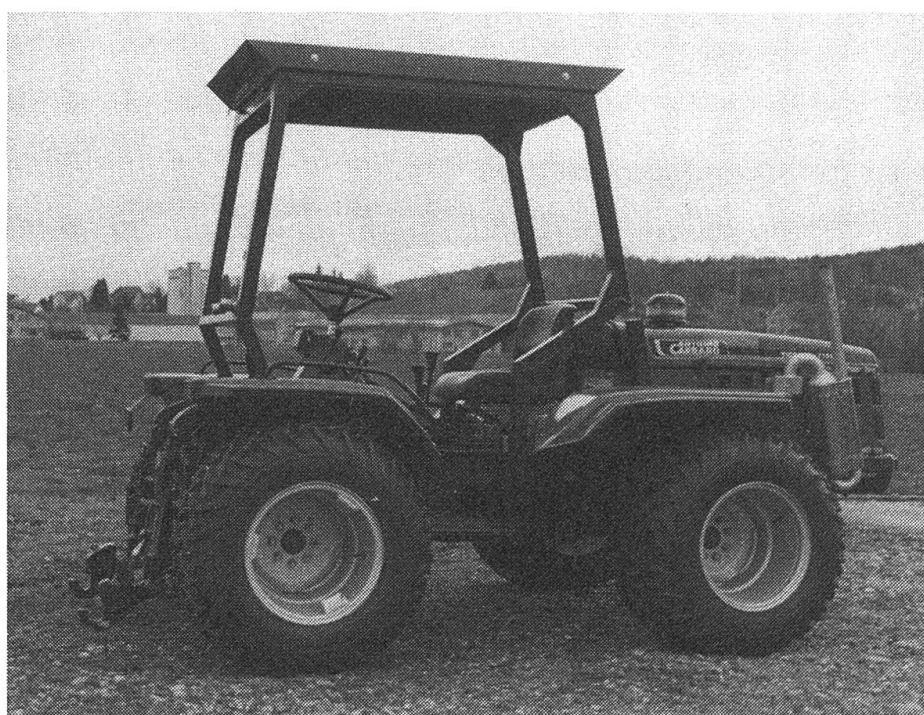
Abb. 3: Zweiwegtraktoren oder sogenannte Wendetracs können dann als interessante Mechanisierungsvariante gelten, wenn damit der Zweittraktor eingespart werden kann. Das wiederum bedeutet, dass die Abmessungen für den Geräteanbau (Dreipunkthydraulik und Zapfwellenanschluss) den entsprechenden Normungen für Normaltraktoren angepasst sein müssten.
