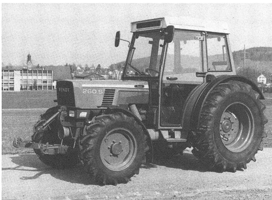
Abb. 2: Für Gewichtsvergleiche muss man berücksichtigen, dass Allradantriebe und Frontanbau das Traktorgewicht um je 150 bis 200 kg und eine integrierte Fahrerschuttkabine um weitere 200 bis 400 kg erhöhen.
