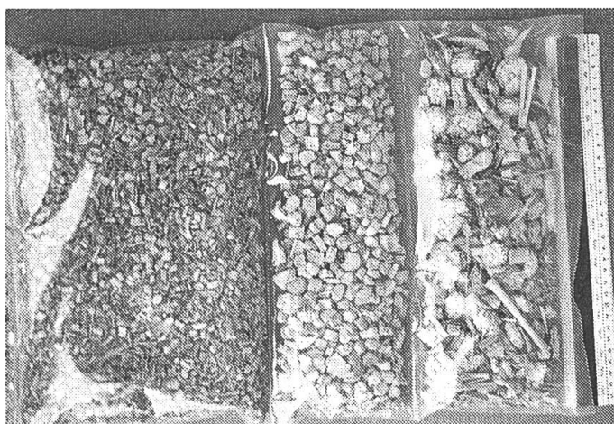
Abb. 6: Häckselproben aus den drei Bewertungsstufen. Häcksellängenanteile bis 4 mm, 4 – 16 mm, über 16 mm.
