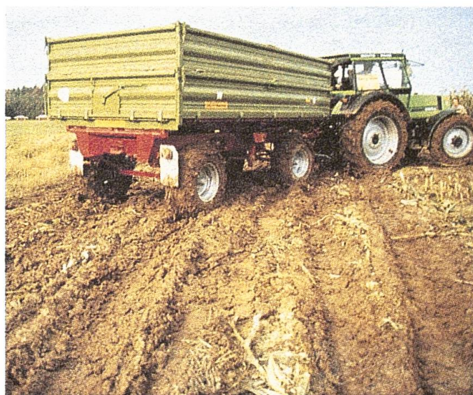
Abb. 1: Die Beachtung der Bodenfeuchtigkeit ist entscheidend für die Vermeidung von Bodenverdichtungen: Bei ungünstigen Verhältnissen verursachen selbst relativ gut ausgerüstete Fahrzeuge Bodenschäden.
