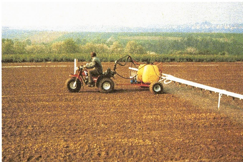
Abb. 3: Das andere Extrem bei der Vermeidung mechanisierungsbedingter Bodenverdichtungen: Verringerung der Fahrspurfläche und Erhöhung der Schlagkraft (zwecks Ausnutzung günstiger Bedingungen) durch grosse Arbeitsbreiten. In diesem Beispiel wird versucht, die Folgen des notwendigerweise hohen Fahrzeuggewichtes durch ein gleichmässiges Verteilen des Gesamtgewichtes auf alle Räder und deren gute Bereifung abzuschwächen.
