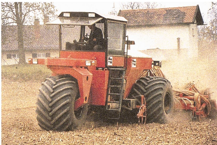
Abb. 2: Das eine Extrem bei der Vermeidung mechanisierungsbedingter Bodenverdichtungen: Verringerung der Druckbeanspruchung durch eine Reduktion des Fahrzeuggewichtes bzw. der Radlasten.
